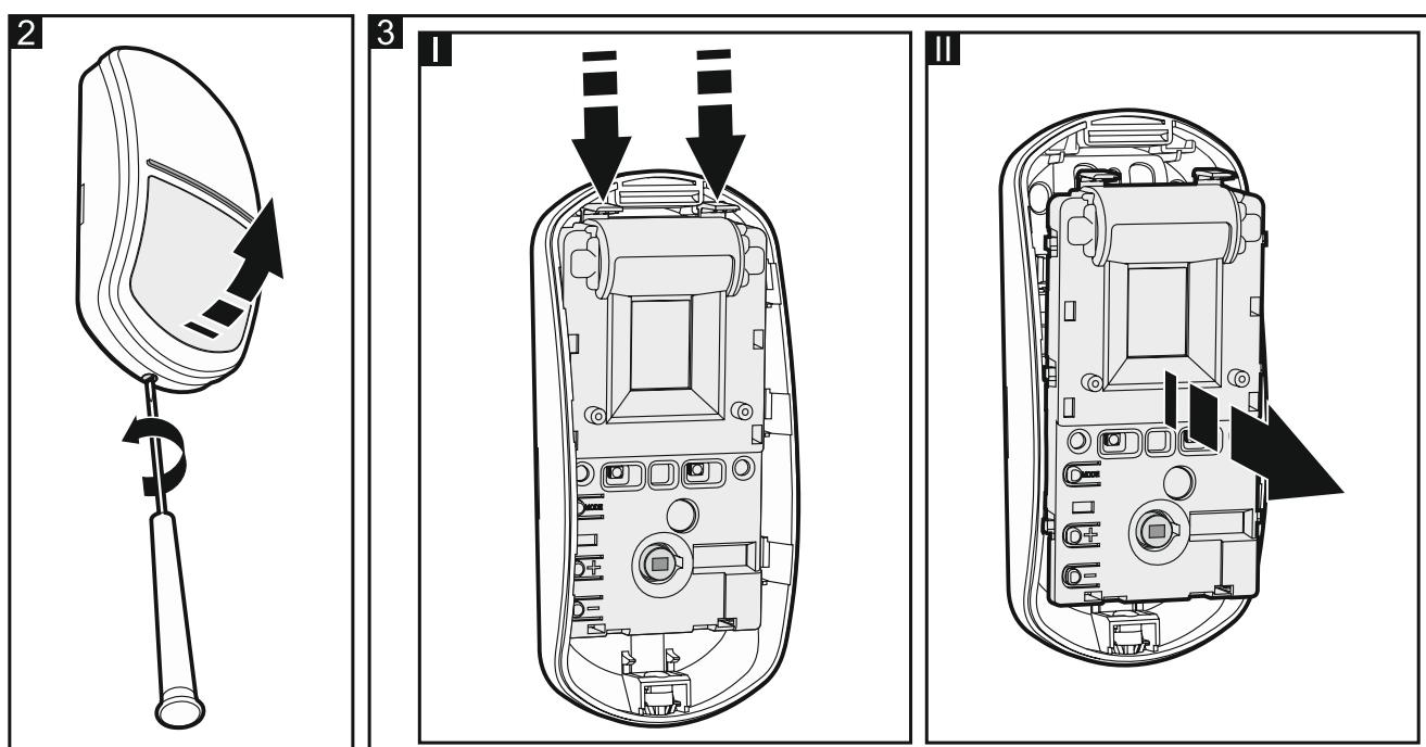
3. Vložiť batériu a pridať detektor do bezdrôtového systému (pozri: príručka kontroléra ABAX 2 / ABAX alebo inštalačná príručka zabezpečovacej ústredne INTEGRA 128-WRL). Nálepka so sériovým číslom, ktoré treba zadať pri registrácii detektora v systéme, sa nachádza na module elektroniky.
