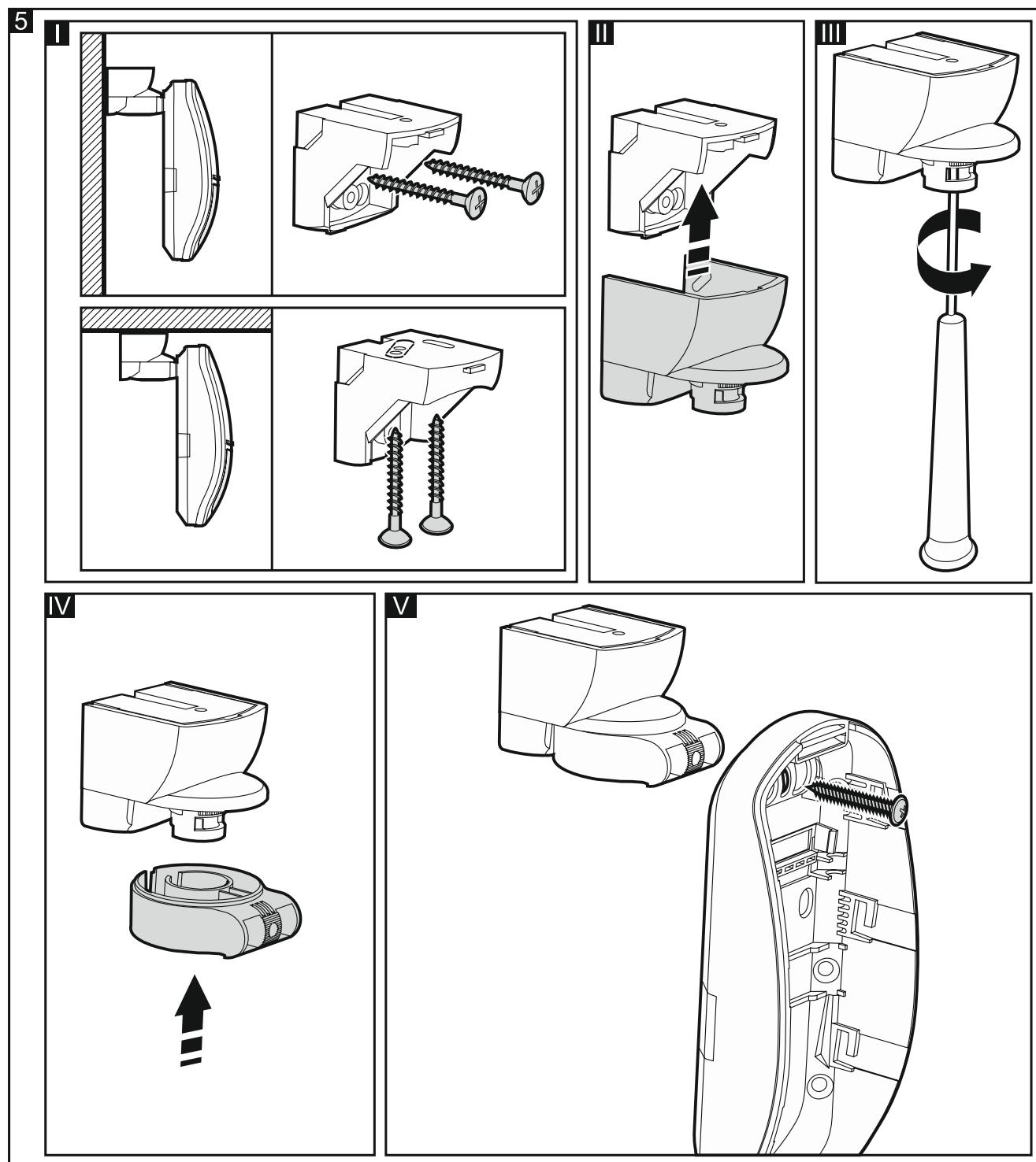
10. Pripevniť základňu krytu na stenu (obr. 4) alebo na konzolu pripevnenú na stenu alebo strop (obr. 5). Hmoždinky dodávané so zariadením sú určené pre stenu typu betón, tehla a pod. V prípade inej steny (sadrokartón, plast), treba použiť iné zodpovedajúce hmoždinky.
