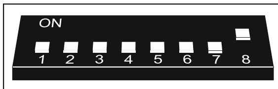
Рис. 9. Способ установки DIP-переключателей в контроллере ACU-120 / ACU-270.
