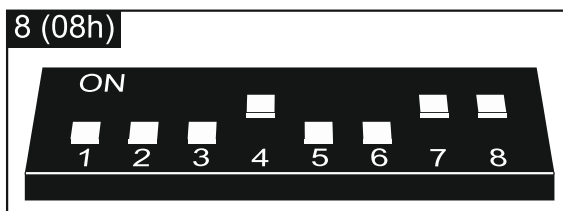
Рис. 10. Способ установки DIP-переключателей в контроллере ACU-100.
