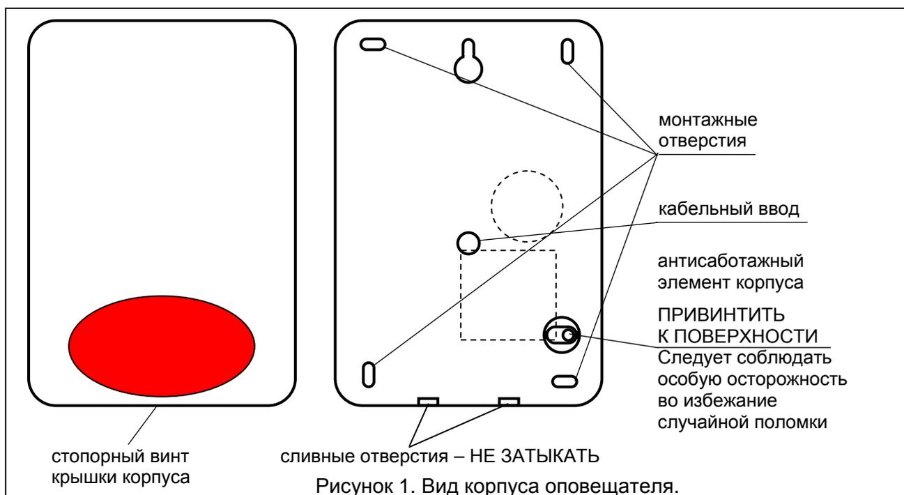
После установки оповещателя рекомендуется уплотнить монтажные отверстия и кабельный ввод силиконовой мастикой.
