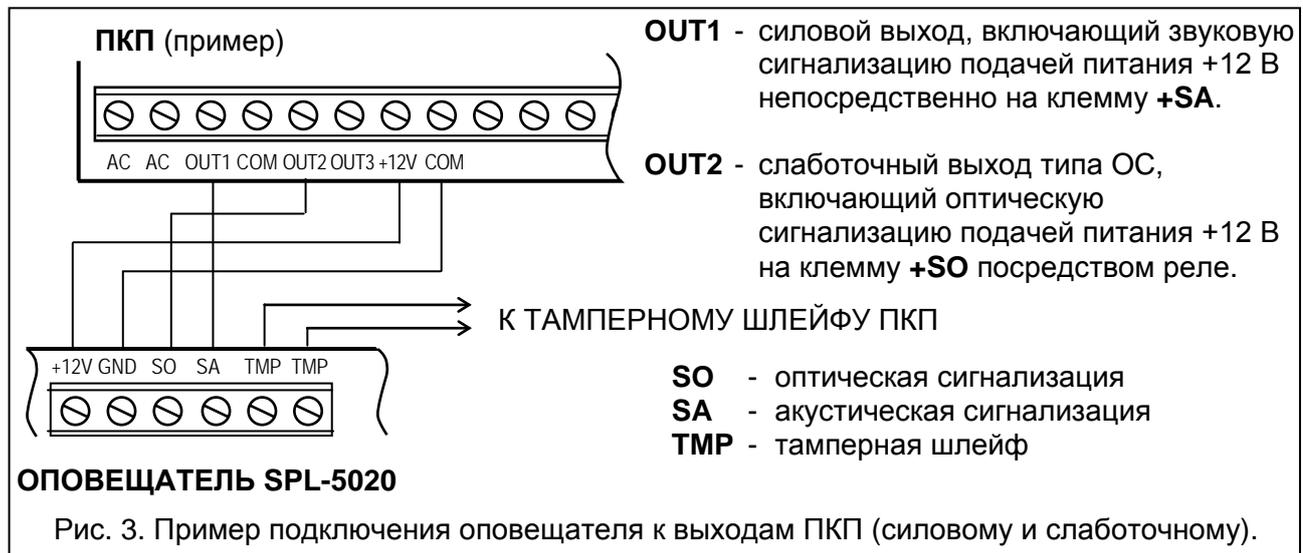
Рис. 3. Пример подключения оповещателя к выходам ПКП (силовому и слаботочному).
