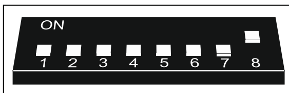
Рис. 9. Способ установки DIP-переключателей в контроллере ACU-120 / ACU-270.
