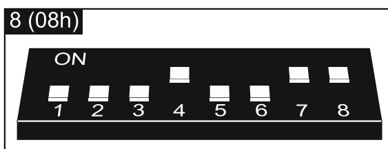
Рис. 10. Способ установки DIP-переключателей в контроллере ACU-100.
