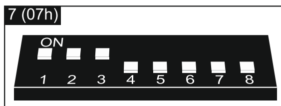
Fig. 9. Adres instelling van de INT-RX-S / INT-RX uitbreiding.
