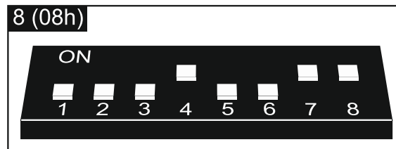
Fig. 10. Mode de réglage des interrupteurs DIP-switch dans le contrôleur ACU-100.
