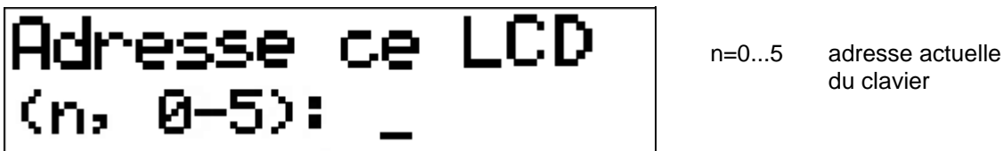
Fig. 26. Programmation de l'adresse du clavier LCD.
