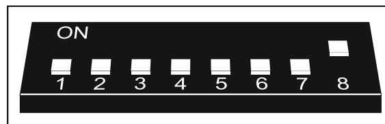
Fig. 13. Mode de réglage des interrupteurs DIP-switch dans le contrôleur ACU-120 / ACU-270.
