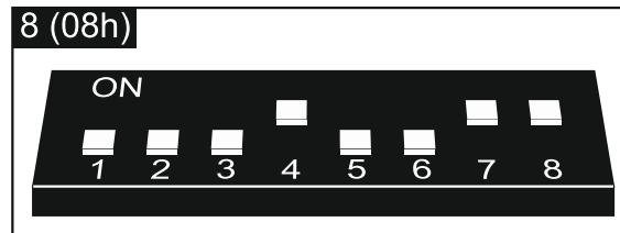
Fig. 10. Demostración de cómo ajustar los interruptores DIP-switch en el controlador ACU-100.
