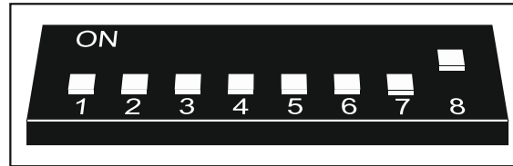
Fig. 9. Demostración de cómo ajustar los interruptores DIP-switch en el controlador ACU-120 / ACU-270.
