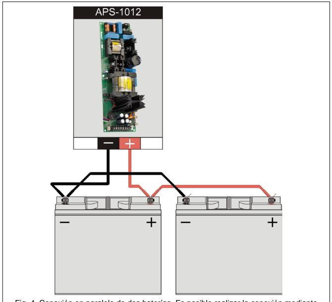
Fig. 4. Conexión en paralelo de dos baterías. Es posible realizar la conexión mediante los cables disponibles en el set junto con el dispositivo.
