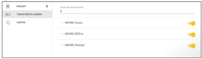
**Länge der Kartennummer** – Anzahl der verwendeten Bytes der Kartennummer. Sie können eine Zahl von 5 bis 8 eingeben.
