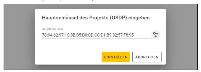
Klicken Sie auf "EINSTELLEN". Das Fenster "Hauptschlüssel des Projekts (OSDP) eingeben" wird geschlossen. Es wird die Registerkarte "PROJEKT" des neu erstellten Projekts angezeigt.
