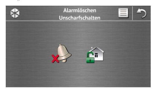
Das Fenster "Alarmlöschen / Unscharfschalten" wird nach dem Antippen des Icons im Hauptfenster angezeigt, wenn ein Alarm auftrat (Alarmspeicher) und mindestens ein Bereich scharf geschaltet ist.
