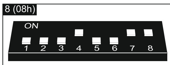
Obr. 10. Nastavení DIP-přepínačů základnové stanice ACU-100.
