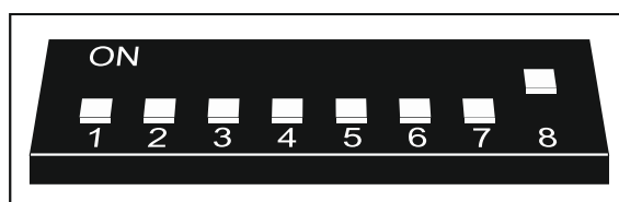
Obr. 9. Nastavení DIP-přepínačů základnové stanice ACU-120 / ACU-270.
