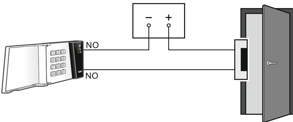
Obr. 2. Pripojenie elektrického zámku na klávesnicu.
