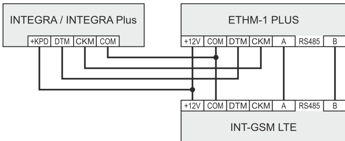
Obr. 5. Spôsob pripojenia modulu INT-GSM LTE na modul ETHM-1 Plus.
