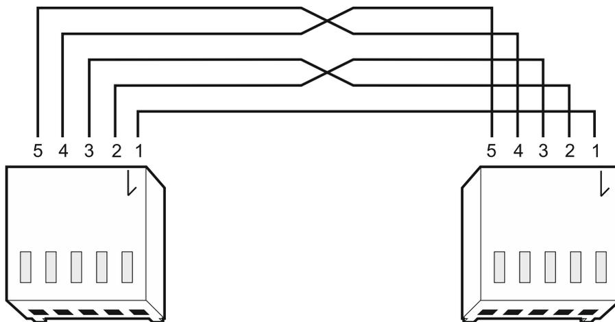
Obr. 4. Schéma kábla na prepojenie portov RS-232 modulu INT-GSM LTE a ústredne INTEGRA s konektorom PIN5.
