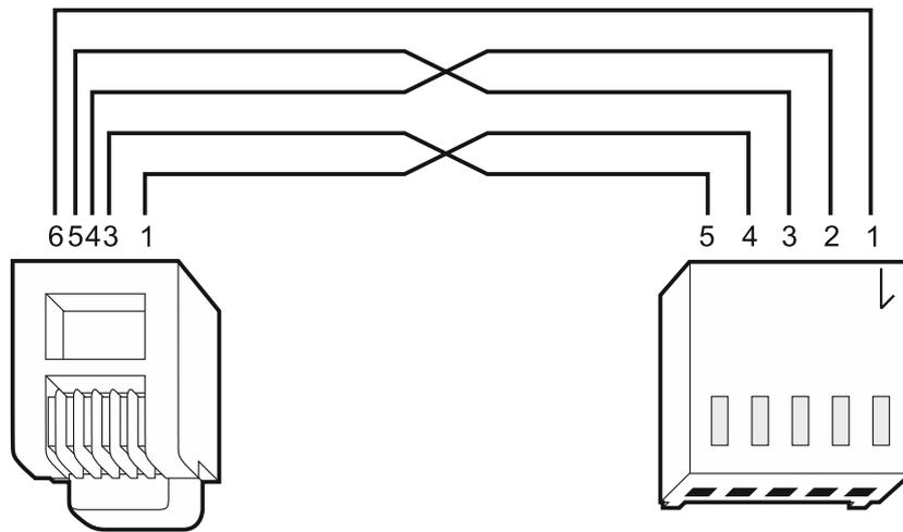
Obr. 3. Schéma kábla na prepojenie portov RS-232 modulu INT-GSM LTE a ústredne INTEGRA / INTEGRA Plus s konektorom typu RJ.
