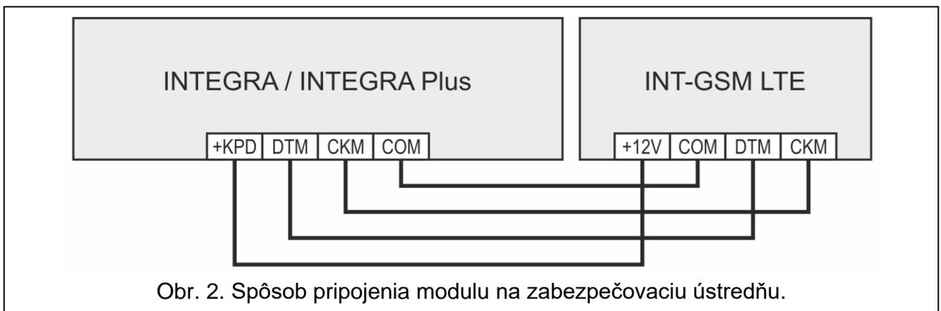
1. Svorky +12V, COM, DTM a CKM modulu prepojiť so svorkami zabezpečovacej ústredne (obr. 2). Na prepojenie svoriek +12V a COM treba použiť pramienkové vodiče s priemerom 0,5-0,75 mm<sup>2</sup> alebo jednožilové vodiče s priemerom 1-2,5 mm<sup>2</sup>. Pri prepojení svoriek DTM a CKM pomocou kábla typu „krútený pár“ treba pamätať, že jedným párom krútených vodičov sa nesmú prepájať signály CKM (clock) a DTM (data). Vodiče zbernice musia byť vedené v jednom kábli.
