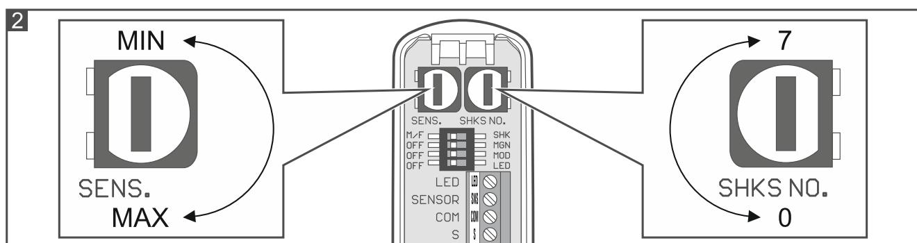
Потенциометр **SENS.** позволяет определить чувствительность извещателя удара (рис. 2). Если зарегистрирован одинарный удар, соответствующий критерию чувствительности, вызывается тревога.
