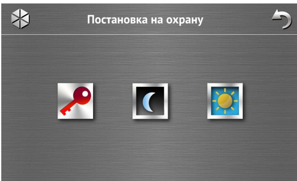
Этот экран отображается, если можно поставить на охрану только один раздел (также в том случае если установщик разрешил быструю постановку на охрану только одного раздела).
