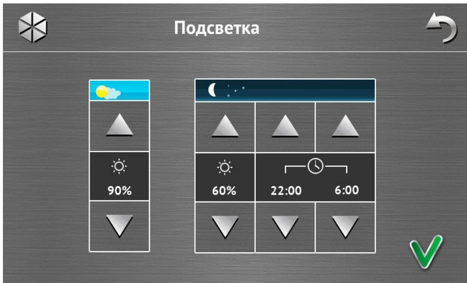
Интенсивность подсветки экрана можно регулировать в пределе 10-100%. В ночное время, продолжительность которого можно определить, интенсивность подсветки может быть другой.
