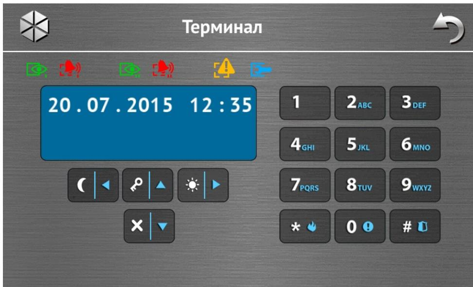
Терминал предназначен для эксплуатации и настройки системы охранной сигнализации аналогично ЖКИ-клавиатуре с текстовым меню. Способ эксплуатации такой клавиатуры описан в руководствах по настройке и эксплуатации приемно-контрольного прибора (эти руководства можно скачать с сайта [www.satel.eu](http://www.satel.eu)).
