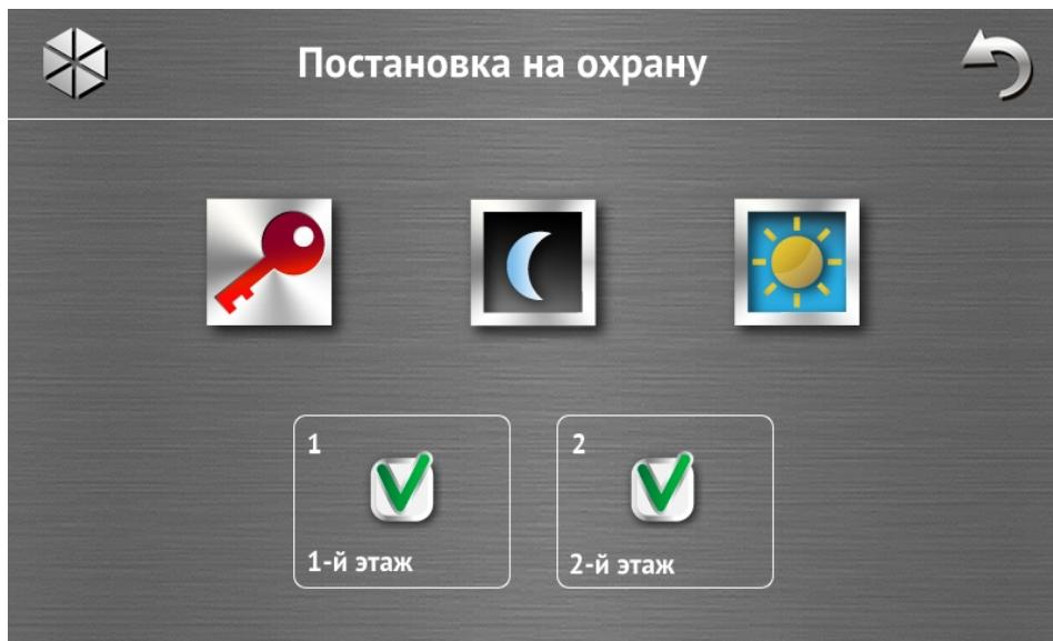
Этот экран отображается, если на охрану можно поставить оба раздела. Разделы отображаются с помощью полей с соответствующим описанием. По умолчанию в полях отображается иконка . Это означает, что разделы должны быть поставлены на охрану. Прикоснитесь к полю, если в разделе не должен быть включен режим охраны (будет отображена иконка ). После выбора разделов для постановки на охрану, прикоснитесь к одной из иконок для выбора режима постановки на охрану.
