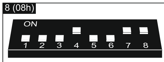
Fig. 10. Mode de réglage des interrupteurs DIP-switch dans le contrôleur ACU-100.
