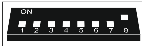
Fig. 9. Mode de réglage des interrupteurs DIP-switch dans le contrôleur ACU-120 / ACU-270.
