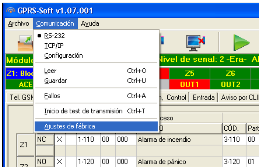
Fig. 15. Comando “Ajustes de fábrica” en el menú “Comunicación”.
