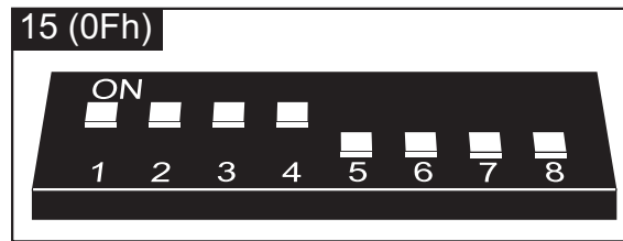
Рис. 18. Способ установки адреса в модуле расширения выходов.
