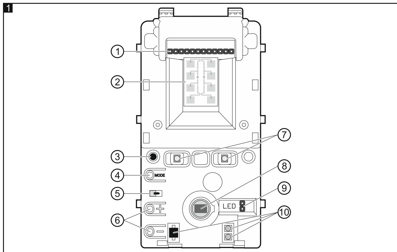
(1) piny pro nastavení výstupů detektoru. Dostupná nastavení jsou znázorněna na obrázcích:
